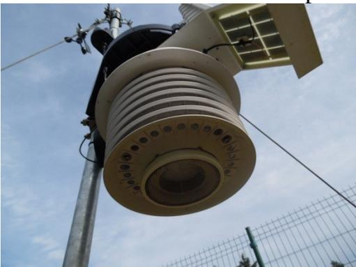
La station météo est placée de manière à ce qu'elle soit exposée au vent donc loin des bâtiments, elle est posée sur de la pelouse (pas sur un sol capable d'isoler la chaleur pour ne pas fausser les mesures)
