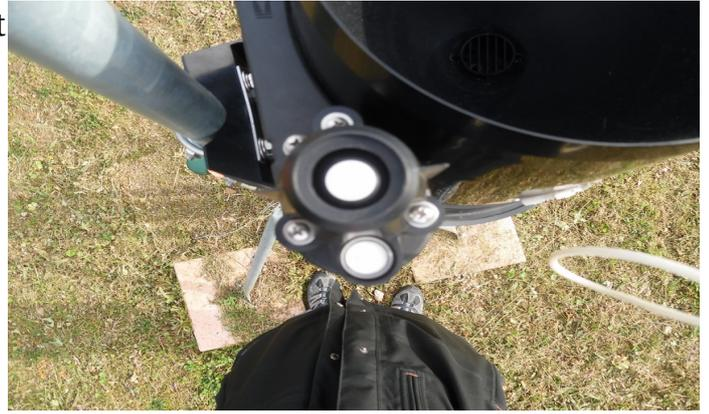
Une sonde UV pour mesurer les ultraviolet ( pas d'unité particulière si ce n'est que un chiffre définit l'ampleur : de 1 à 9)
