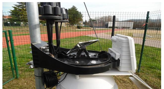
Un pyranomètre pour mesurer le rayonnement solaire (en  $\text{wh/m}^2$ )
