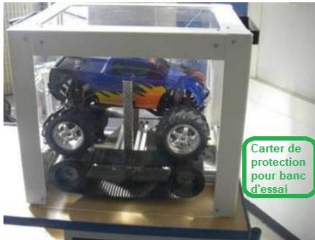
Carter de protection pour banc d'essai
